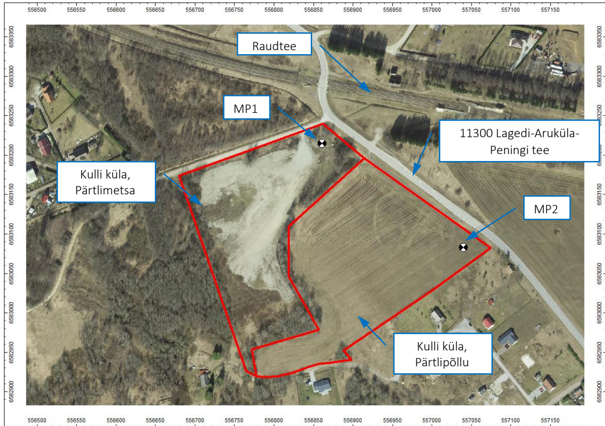
Joonis 3. Mõõra ja vibratsiooni mõõtmispunktide paigaldusskeem. Planeeringuala markeeritud kaardil punasega
